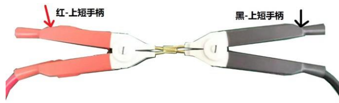
图 2-4-5 开尔文测试夹清零方法
